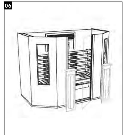
06 Restliche Strahler nach Montageanleitung montieren. Türe befestigen und einstellen.
