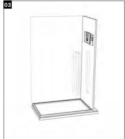
03 Seitenwand der Infrarotkabine an der vorgegebenen Position fixieren und festschrauben. Strahler nach Montageanleitung in die Rückwand montieren.
