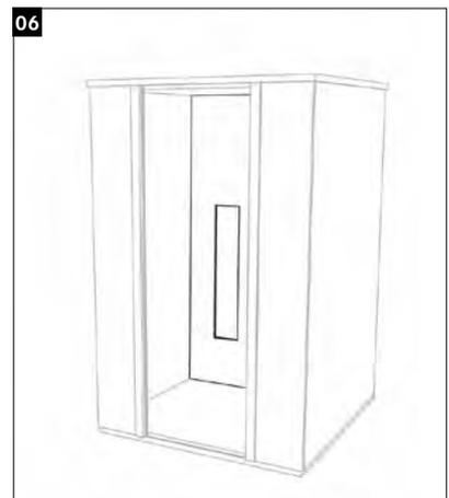
06 Rückwand mit den Winkeln an die Seitenwand schrauben.
