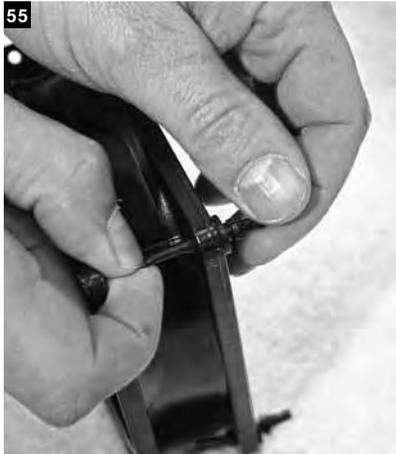
Für die Montage des Lüfters die Gummipuffer auf der Unterseite des Lüfters anbringen (das Etikett des Lüfters muss nach oben schauen).
