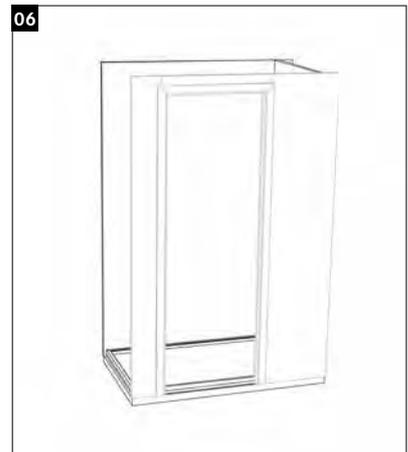
06 Montage bei Schiebetür: Vorderwand an der vorgegebenen Position festschrauben.
