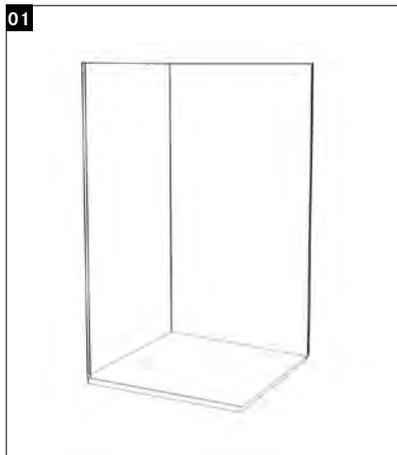
01 Bodenplatte auf waagrechten Boden legen (mit Wasserwaage prüfen!). Rückwand und linke Seitenwand montieren.
