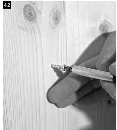
Nun die Schrauben für die Rückenlehne an den vorgegebenen Markierungen in das Bedienungspaneel schrauben.
