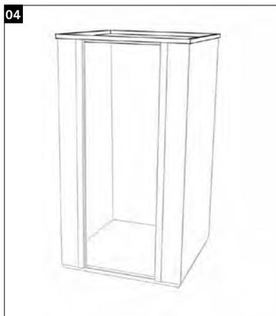
04 Deckenpaneel aufsetzen und festschrauben.
