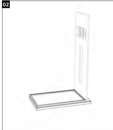
02 Rückwand in die Bodenplatte stecken und mit Schrauben befestigen.
