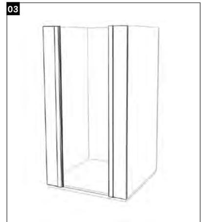
03 Je nach Türanschlag Vorderwand Teil 1 und Teil 2 richtig montieren. Der Türanschlag kommt auf die Seite mit den Bohrungen auf der Vorderwand (Teil 2).
