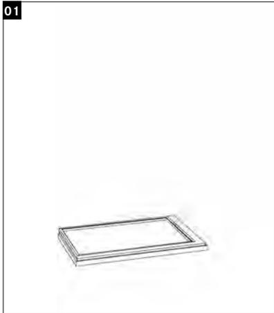
01 Bodenplatte auf waagrechten Boden legen (mit Wasserwaage prüfen!) und Schrauben bereit legen.
