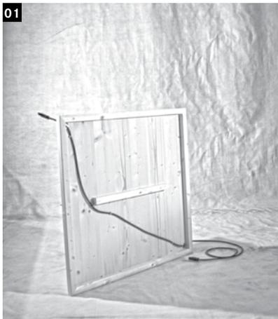
Die Verlängerungsleitung mit Buchse und Stecker (350 cm) durch die runden Ausschnitte in der Bodenplatte ziehen und mit Nagelschellen fixieren.
