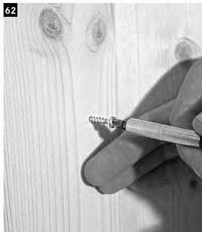
62 Nun die Schrauben für die Rückenlehne an den vorgegebenen Markierungen in das Bedienungspaneel einschrauben.
