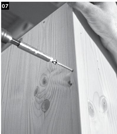
Die Rückwand an der linken Seitenwand an den Vorbohrungen verschrauben! Darauf achten, dass die Teile auf der Oberseite bündig sind!
