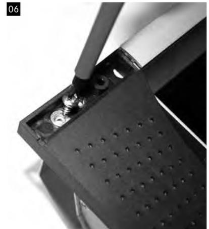
Dafür die äußersten Schrauben an den Ecken des Strahlers herauserschrauben und den Strahler vorsichtig vom Einbaugeschäse lösen.
