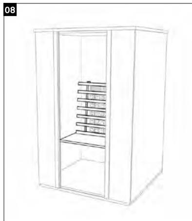
08 Leisten der Sitzbank an den vorgesehenen Stellen montieren und darauf die Sitzbank legen. Schrauben für die Rückenlehne in die Rückwand schrauben und die Rückenlehne daran aufhängen.
