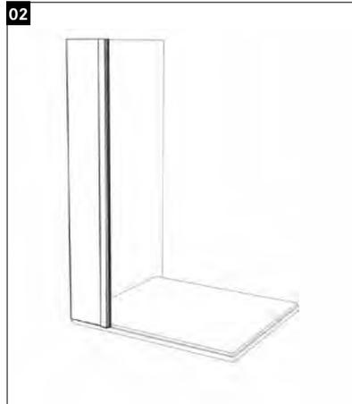
02 Je nach Türanschlag Vorderwand Teil 1 oder Teil 2 richtig montieren. Der Türanschlag kommt auf die Seite mit den Bohrungen auf der Vorderwand (Teil 2).
