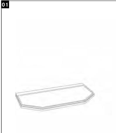
01 Bodenplatte auf waagrechten Boden legen (mit Wasserwaage prüfen!) und Schrauben zurechtlegen.
