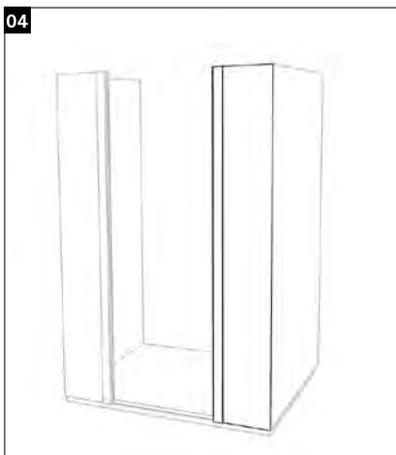
04 Zweiten Vorderwandteil an der rechten Seitenwand montieren.
