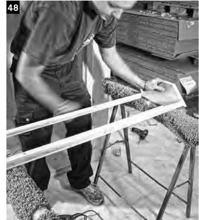
Als nächstes das Strahlerpaneel zur Hand nehmen und mit dem Brandschutz auskleiden.
