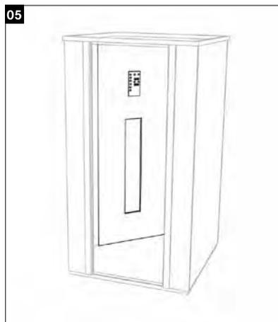
05 Bedienungspaneel richtig verkabeln und mit Brandschutz versehen. Danach in der Infrarotkabine im rechten hinteren Eck montieren.
