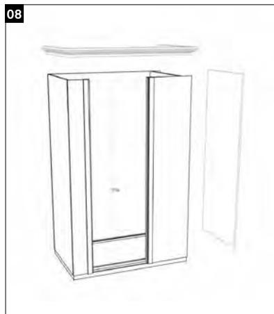
08 Deckenplatte auflegen und von oben festschrauben. Türe und Verblendung der Seitenwand montieren.
