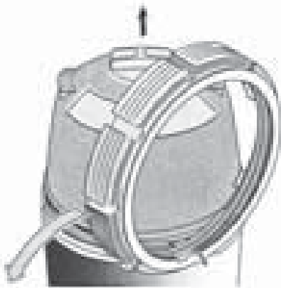
Abbildung 6: Gewinding nach vorne abrollen, zum Lösen der Filterhälften.
