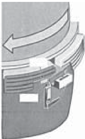
Рисунок 3: поворачивать резьбовое кольцо, пока оно не попадет в паз предохранительной накладки.
