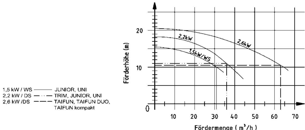
**Pumpenleistung:** 1,5 kW / WS, 230 Volt 50 Hz. Strömungsgeschwindigkeit 2 m vor der Düse 1,2 m/sec.
