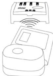
Encoche pour IR transmission de données
