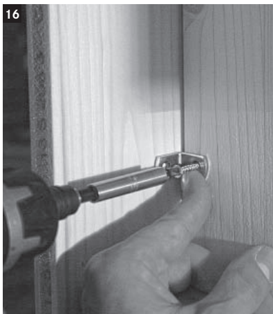
16 Mit den beige packten Winkeln wird nun die Rückwand mit den Seitenteilen verbunden.
