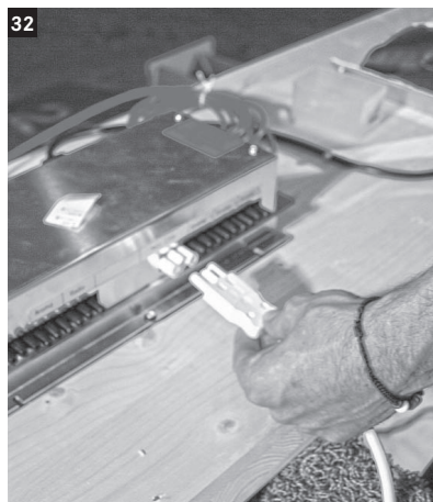
Die Buchse der Anschlussleitung (500 cm) am weißen Gegenstück am Leistungsteil anstecken.
