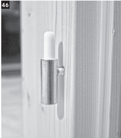
46 Die beiden Beschläge für die Angelglastür in die Vorderwand Teil 2 schrauben. Soweit, dass noch ca. zwei Gewindedrehungen zu sehen sind.
