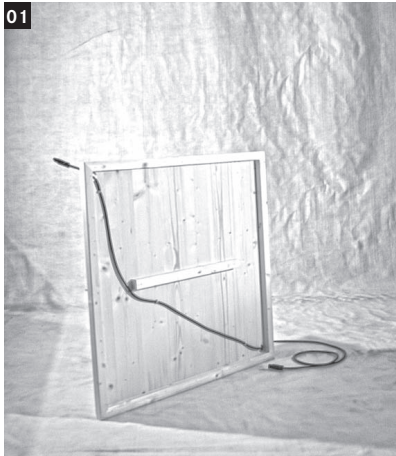
01 Die Verlängerungsleitung mit Buchse und Stecker (350 cm) durch die runden Ausschnitte in der Bodenplatte ziehen und mit Nagelschellen fixieren.
