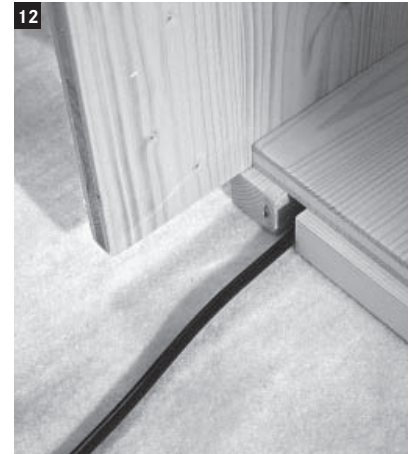
12 Die Verlängerungsleitung soll beim Ausschnitt an der Rückseite der Bodenplatte herausragen.
