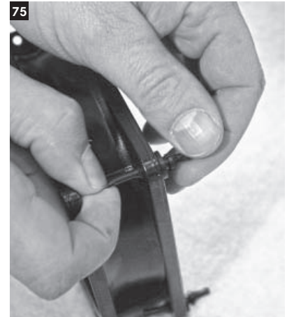
75 Für die Montage des Lüfters die Gummipuffer auf der Unterseite des Lüfters anbringen (das Etikett des Lüfters muss nach oben schauen).
