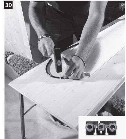
Die Verlängerungsleitung mit Buchse und Stecker (250 cm) zur Hand nehmen. Das Ende mit der Buchse durch den Ausschnitt für den Strahler ge- ben (ca. 10 cm) und das Kabel mit Nagelschellen am Bedienungspaneel fixieren.
