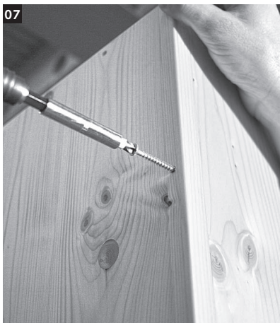
07 Die Rückwand an der linken Seitenwand an den Vorbohrungen verschrauben! Darauf achten, dass die Teile auf der Oberseite bündig sind!
