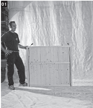
01 Die Verlängerungsleitungen mit Buchse und Stecker (350 cm) durch die runden Ausschnitte in der Bodenplatte geben und mit Nagelschellen fixieren.
