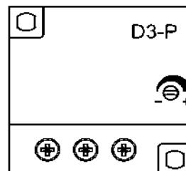
An der Regulierschraube des Druckwellenschalters kann der Ansprechdruck eingestellt werden.
