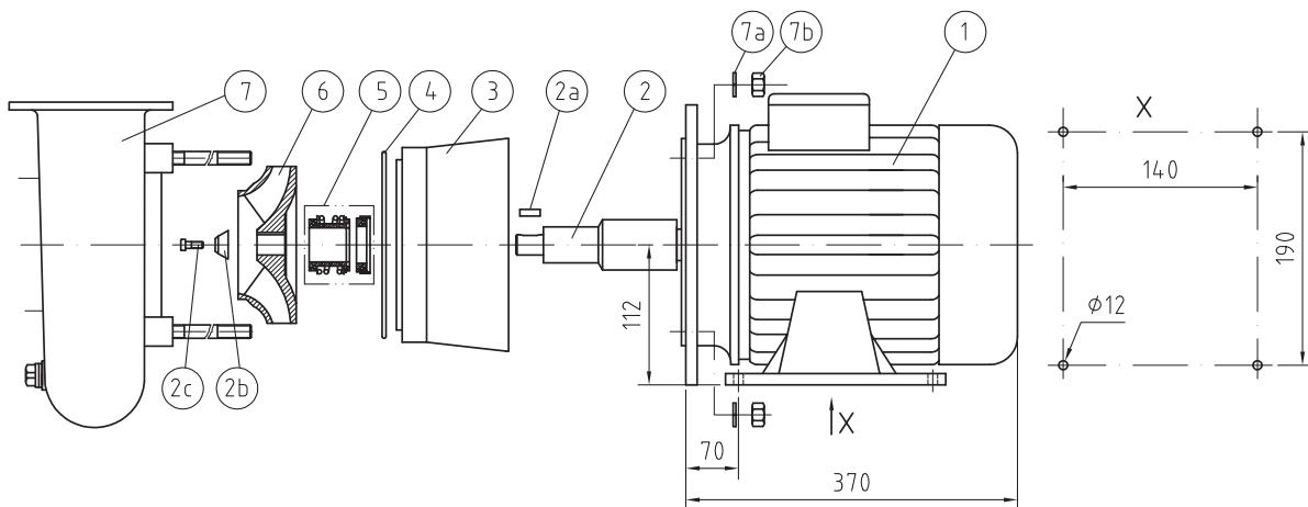
**Pumpen mit 4 kW, DS / pumps with 4.0 kW rotating current / pompes de 4,0 kW, tri**
