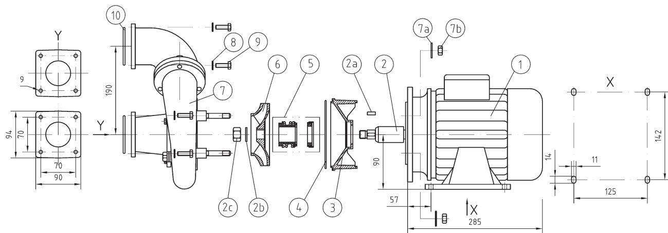
**Pumpen mit 2,6 kW, DS / pumps with 2.6 kW rotating current / pompes de 2,6 kW, tri**
