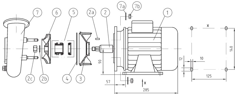
**Pumpen mit 2,2 kW, WS / pumps with 2.2 kW alternating current / pompes de 2,2 kW, mono**
