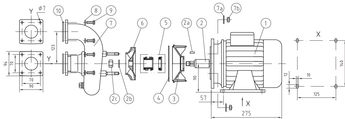
**Pumpen mit 1,5 kW, WS / pumps with 1.5 kW alternating current / pompes de 1,5 kW, mono**
