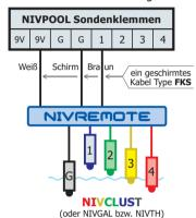
Die Verbindung zum NIVPOOL erfolgt über ein einziges geschirmtes zweipoliges Kabel mit der Artikel Nr. FKS. Entfernungen von 500m sind problemlos möglich. Über dieses Kabel erfolgt nicht nur die Datenübertragung in beide Rich-
