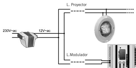
Es necesario instalar un modulador para cada uno de los transformadores existentes en la instalación.
