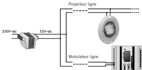
Évitez d'installer les lignes d'alimentation de 12V ~AC des lampes et des modulateurs à proximité de possibles interférences électriques d'autres signaux.
