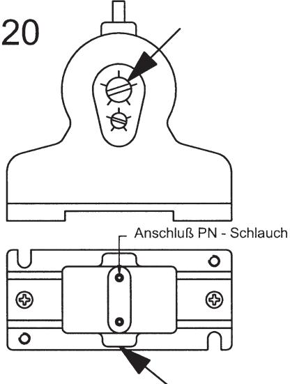
An der Regulierschraube des Druckwellenschalters kann der Ansprechdruck eingestellt werden.
